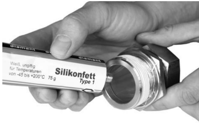
Abb. 10-30 Einfetten der Sensorverschraubung
