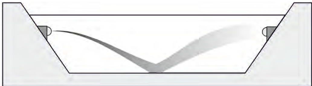
Abb. 9-4 Extremer senkrechter Dichteunterschied durch Salzgehalt (Prinzip)
