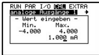
Abb. 25-11 Abgleich der analogen Ausgänge
