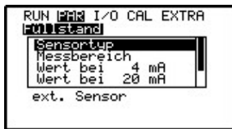
Abb. 23-12 Anzeigebeispiel bei externem Füllstandsensor
