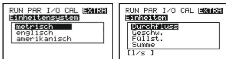
Abb. 22-3 Wahl Einheitensystem und Einheiten
