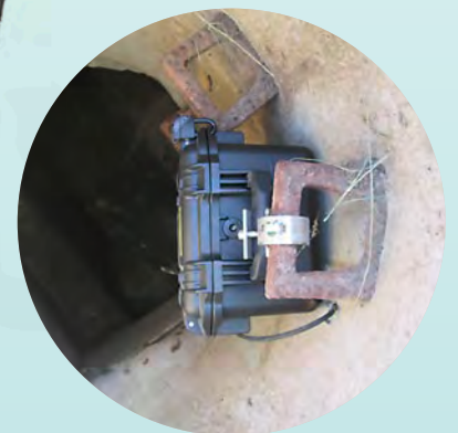
NivuLevel Mobile Messumformer mit Mobilfunkdatenübertragung
