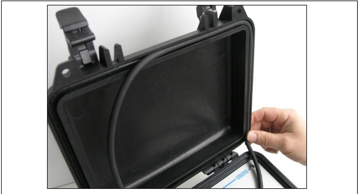
Abb. 3-4 Neue Dichtung einlegen / Insert new gasket
