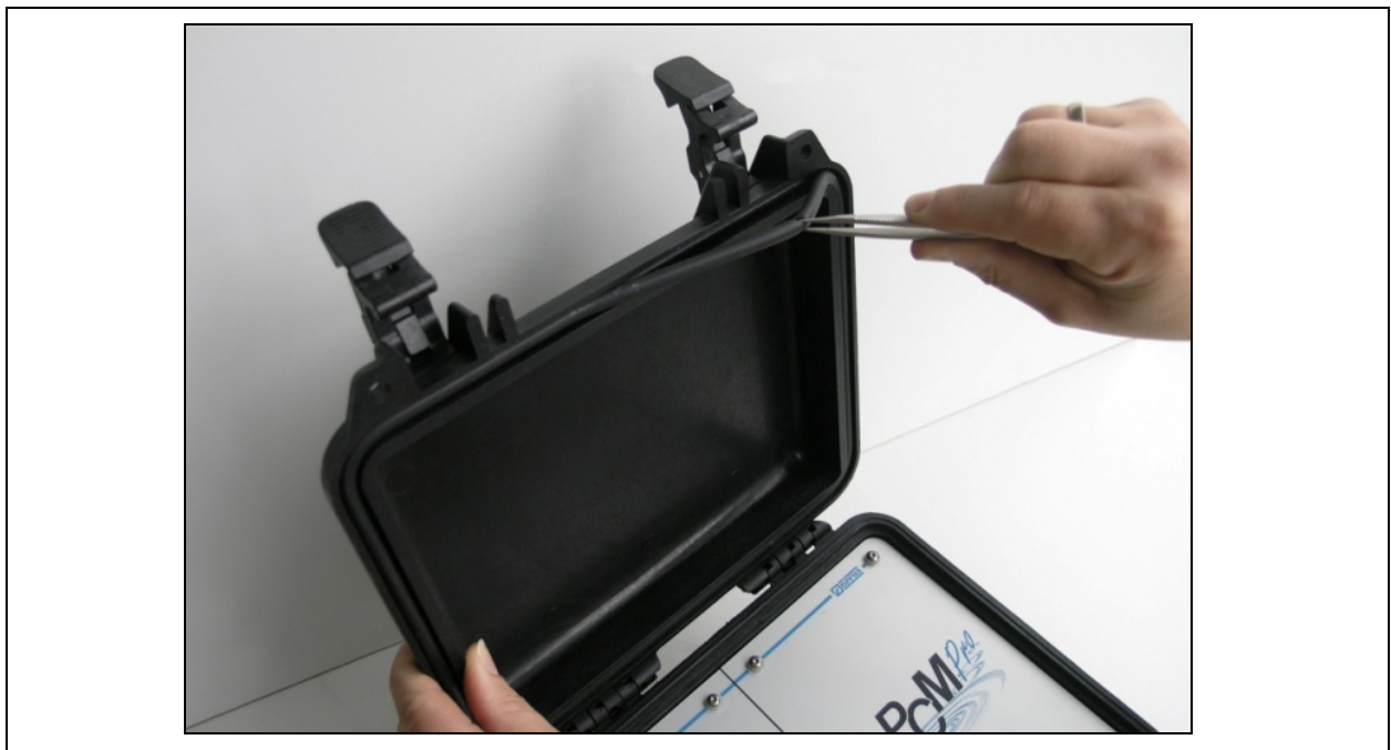
Abb. 3-1 Alte Deckeldichtung entnehmen / Remove old lid gasket
