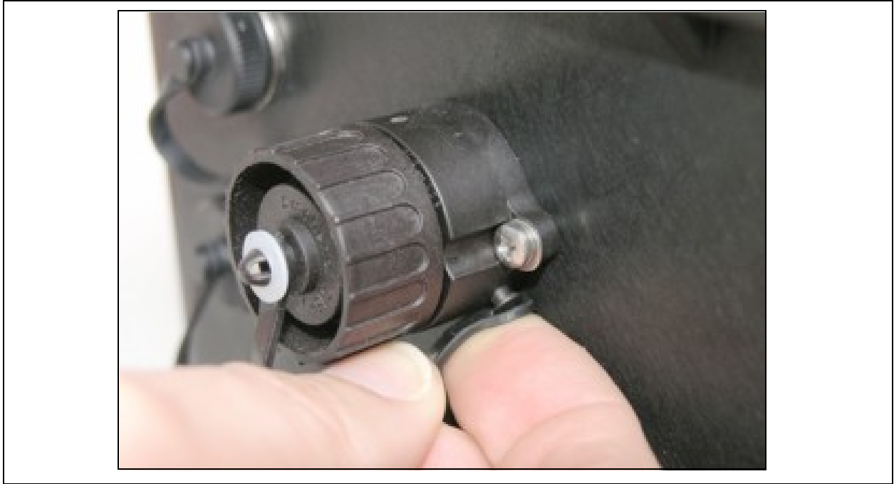
Abb. 5-1 Schutzkappe entfernen / Remove protective cap
