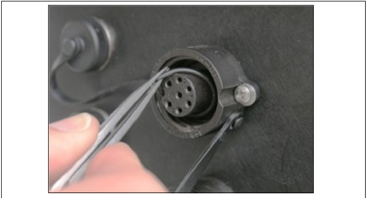
Abb. 4-1 O-Ring mit einer Pinzette entfernen Remove O-ring with tweezers
