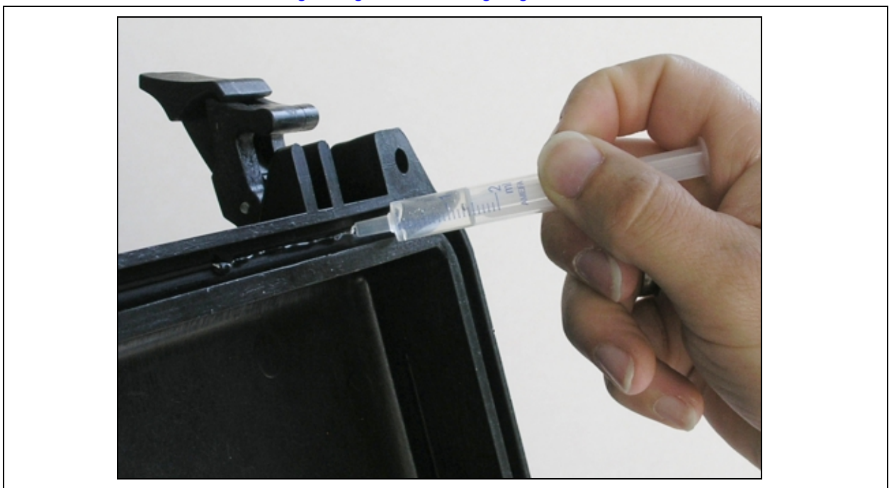
Abb. 3-3 Kleber vorsichtig auftragen / Apply adhesive carefully
