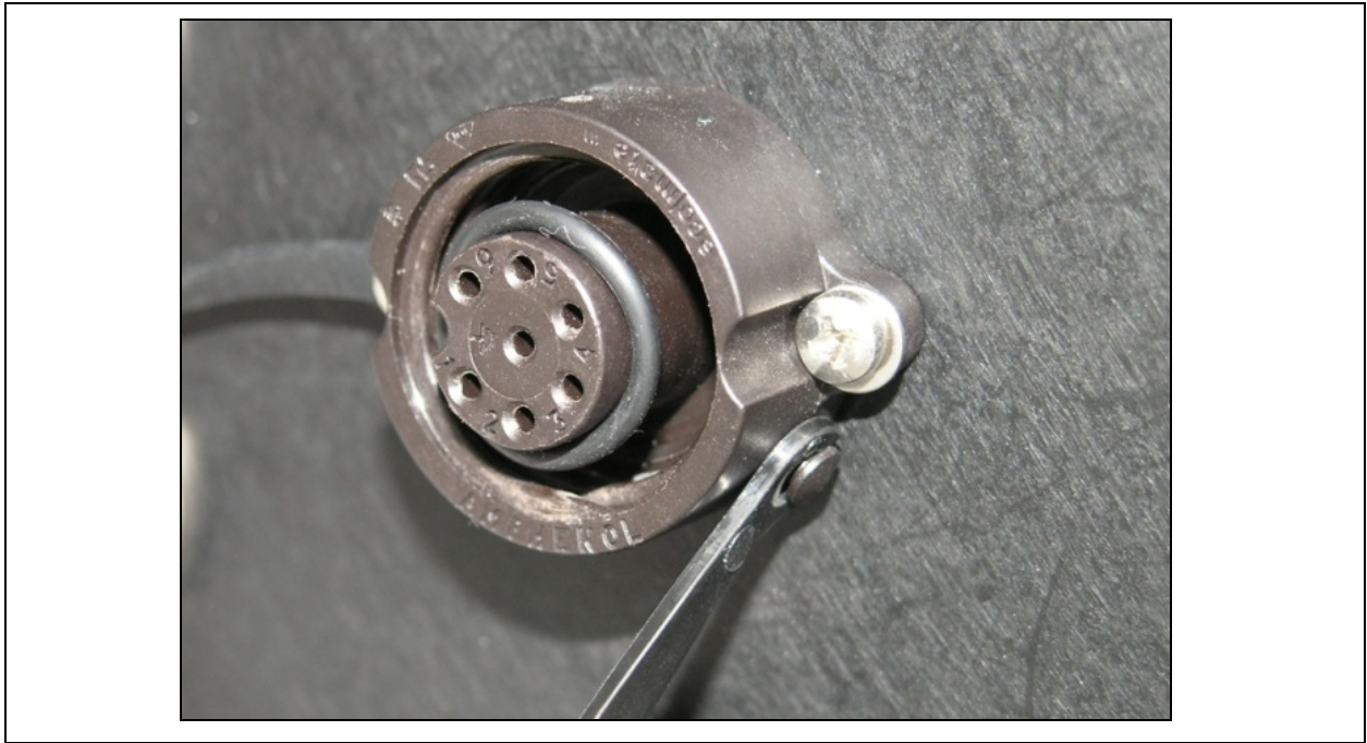
Abb. 4-2 Einsetzen des neuen O-Rings / Insert new O-ring
