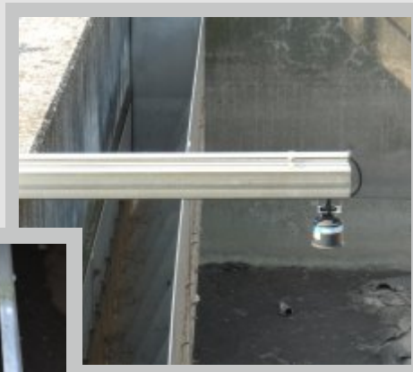
Bassin avec capteur de niveau et enregistreur de données installés
