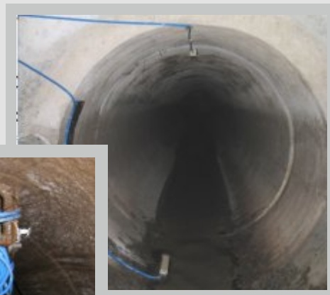
Point de mesure dans le canal - Convertisseur avec enregistreur dans le regard
